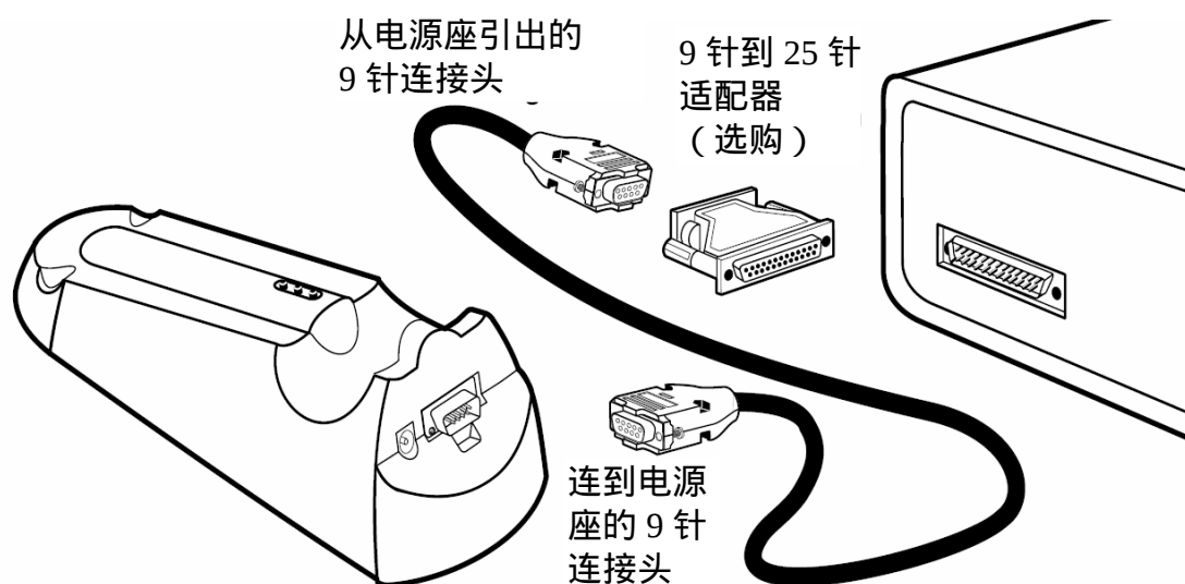
图 8 RS232 缆线连接
